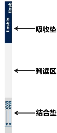
图 1. 一次性核酸检测试纸条结构示意图
